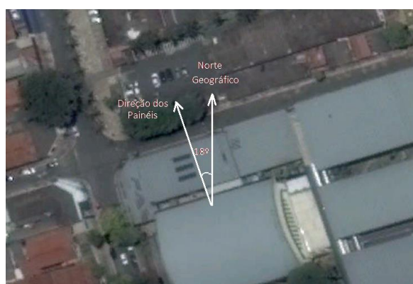
Figura 21 - Direção dos painéis fotovoltaicos, obtido pelo Google Earth com adaptações
